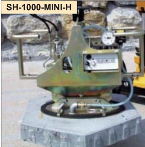
Für das wirtschaftliche und sichere Handling von schweren Lasten bis 1.000 kg, wie z.B. Granitplatten, „saugdichte Betonelemente“, Marmorplatten, Bordsteine, Trittstufen, Rohren usw.
