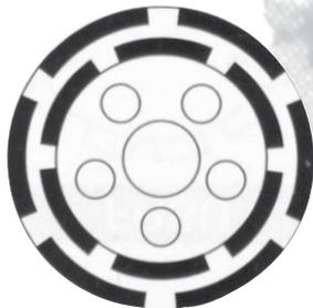
Universaltyp für gleiche Anwendung wie Typ S, jedoch mit doppelter Segmentreihe für schwere Arbeiten; auch für Flächenschliff besonders gut geeignet
