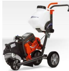
Schnitttiefe ist leicht einstellbar. Mit einem Führungswagen ist es einfach gerade bzw. gebogene Schnitte zu erstellen, auch nahe an Wänden und Randsteinen. Kompakte Bauweise, leicht hochzuklappen und zu transportieren.
