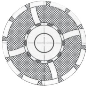
für den universellen Einsatz auf Beton und Hartgestein mit PU-Ausschäumung für ruhigen Schliff und Kantenbearbeitung
